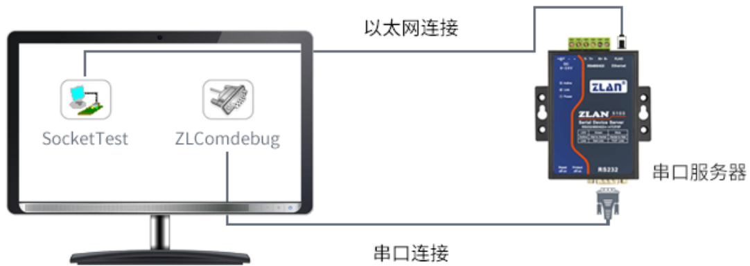
图 10 TCP 通讯示意图
