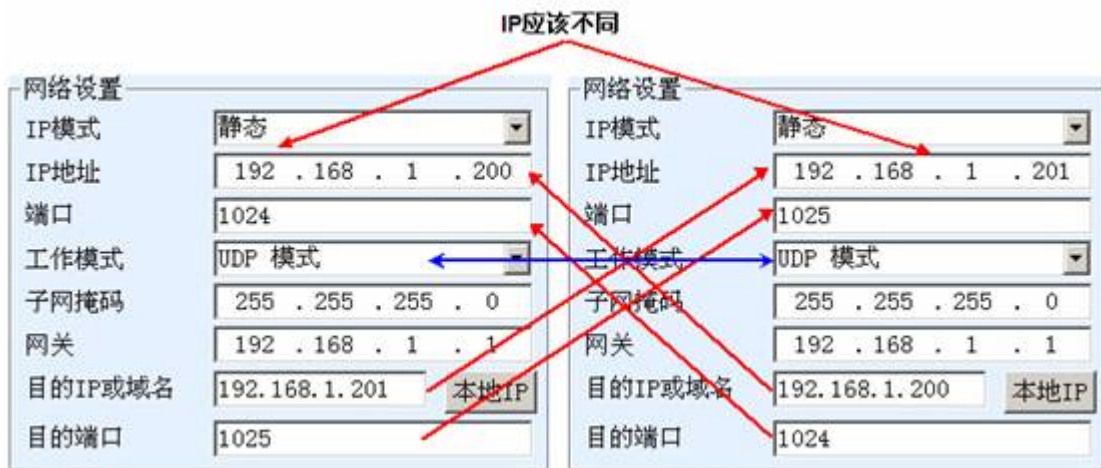
图 27 UDP 设备对联参数配置
